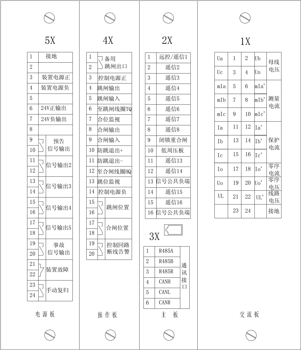
附图 1 CHR9612 数字式线路保护测控装置背板端子图
